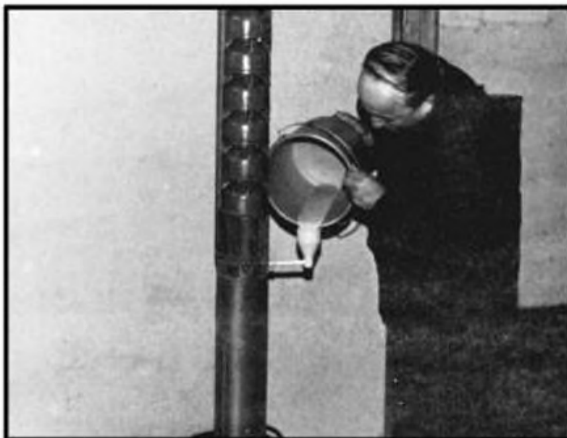
شکل ۱۶- روش آماده کردن الکتروموتور شناور
